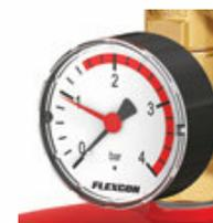
I anslutning till expansionskärlet för kollektorn finns en mätare för drifttrycket. Trycket bör vid stillastående anläggning vara mellan 0,5 och 1,5 bar. Understiger trycket 0,5 bar bör efterfyllning ske.
