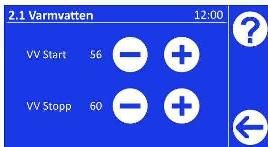
**OBSERVERA** att om du höjer dessa värden så påverkas drift-ekonomi. Om de ställs upp för högt kan också trycket i värmepumpen stiga så högt att den löser ut och larmar för högtryck. Standardinställning är 55 grader som kan höjas till max 60.
